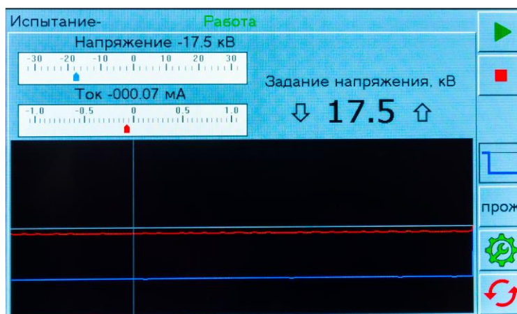
Рис. 12 режим работы генератора - «Испытание -»
