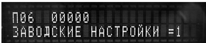
Рис. 12 Установка исходных параметров генератора
