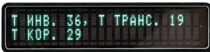
Слайд 8.6 температура радиатора инвертора, корректора и выходного трансформатора
