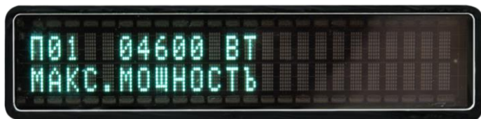
Слайд 9.1 П01 – Максимальная мощность генератора.
